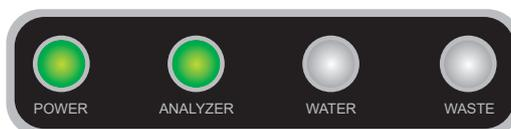
Quando a terceira lâmpada vermelha está acesa com alarme, significa que o equipamento está sem água.
